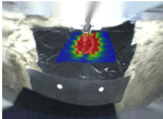
Fig.4 Visualized metal detector data.
